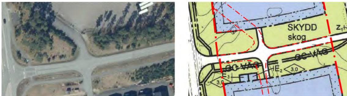
T.v. Ortofoto som visar den utbyggda korsningen. T.h. Utdrag från plankartan med markering för korsningens egentliga utformning och positionering. Källa: Kristianstads kommun
